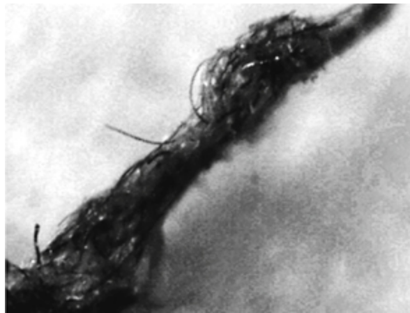
Abb. 14: Geflecht aus mehreren Nano-Fasern
