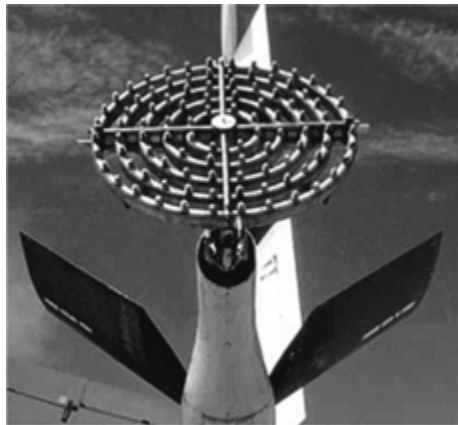
Abb. 9: Sprühanlage am Heck eines Flugzeugs
